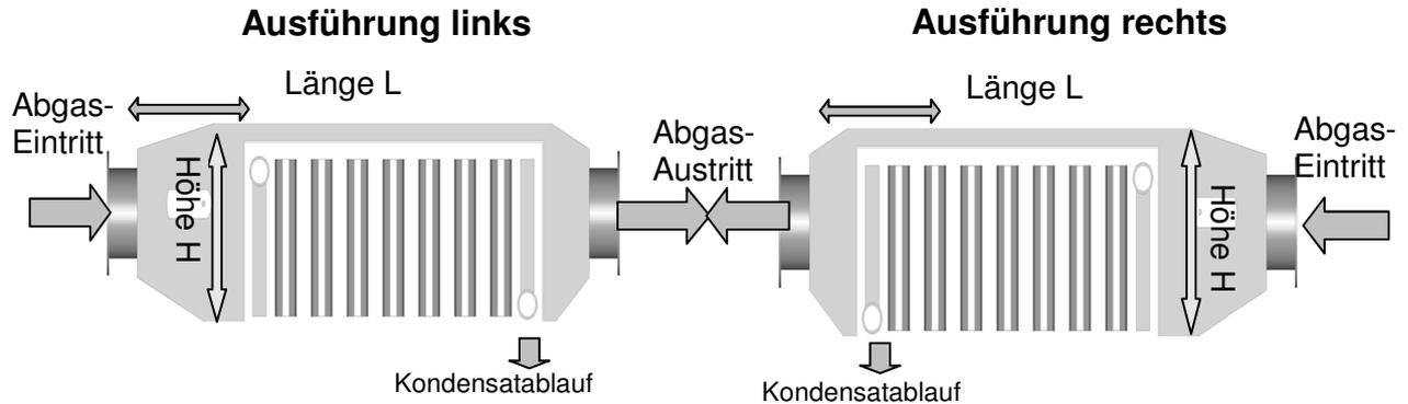
Die Wärmetauscher werden in spiegelbildlich gleichen Ausführungen 'links' oder 'rechts' geliefert. Auf Wunsch können auch Ausführungen für senkrechten Einbau geliefert werden. Im Register der Abgaswärmetauscher ist ein Tauchrohr mit Temperaturfühler eingebaut, der in Verbindung mit einem Regler eine effiziente Regelung der Ladepumpe ermöglicht. Die Ausführungen mit internem Abgas-Bypass sind mit einem Stellantrieb mit Federrücklauf ausgerüstet.
